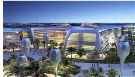
شكل ( 32 ) تصميم المظلات المتحركة التي تفتح نهارا و تغلق ليلا تبعا لضوء الشمس و ذلك لتوفير الطاقة المستهلكة في المدينة.
